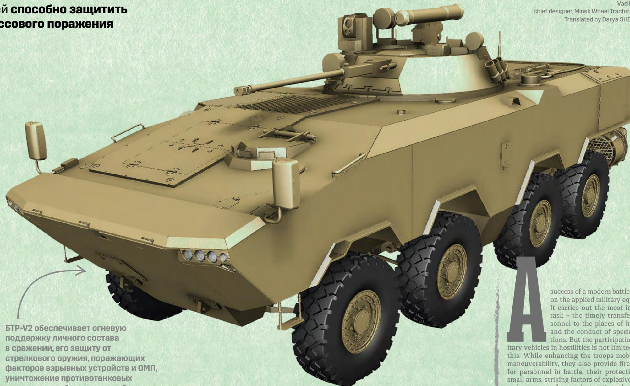
БТР-V2 обеспечивает огневую поддержку личного состава в сражении, его защиту от стрелкового оружия, поражающих факторов взрывных устройств и ОМП, уничтожение противотанковых средств, легкобронированной техники и танков, а также малоскоростных воздушных целей противника.
