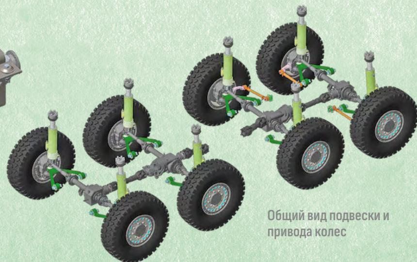
Общий вид подвески и привода колес
