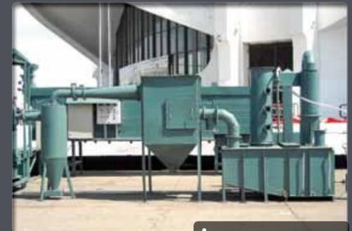
Система очистки газов
