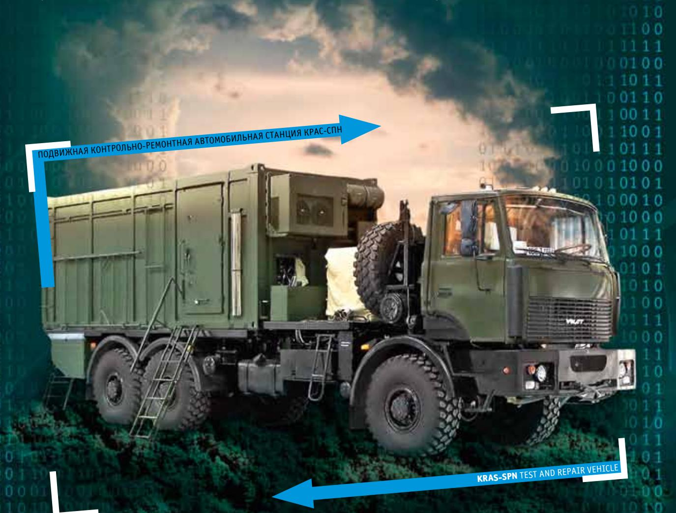
При изменении технологической комплектации подобная ремонтная автомобильная станция может быть создана для повышения оперативности обслуживания и ремонта средств связи, электронных узлов и модулей бронетанковой техники...
