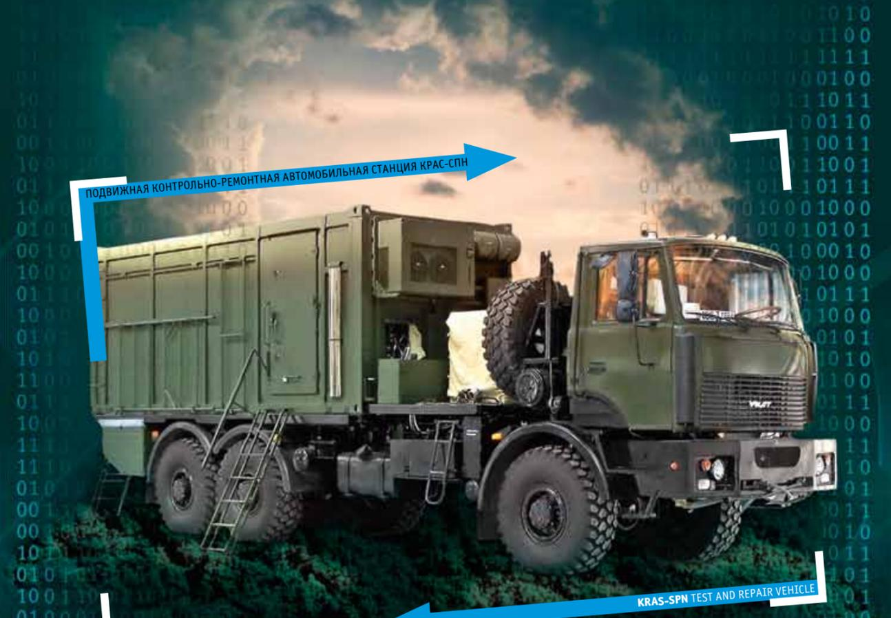
При изменении технологической комплектации подобная ремонтная автомобильная станция может быть создана для повышения оперативности обслуживания и ремонта средств связи, электронных узлов и модулей бронетанковой техники...
